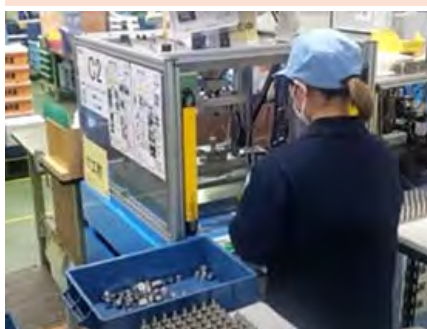
カシメ接合自動機B (カシメ接合加工:中央)
