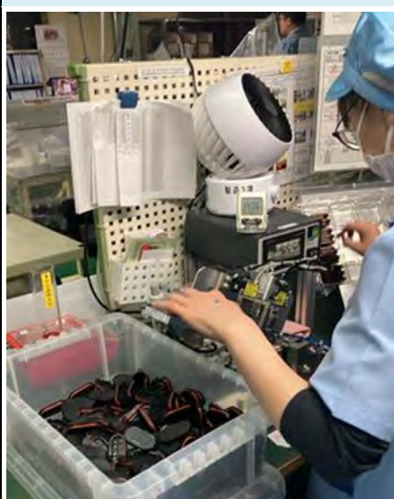
専用器具を使った検査(圧着度)
