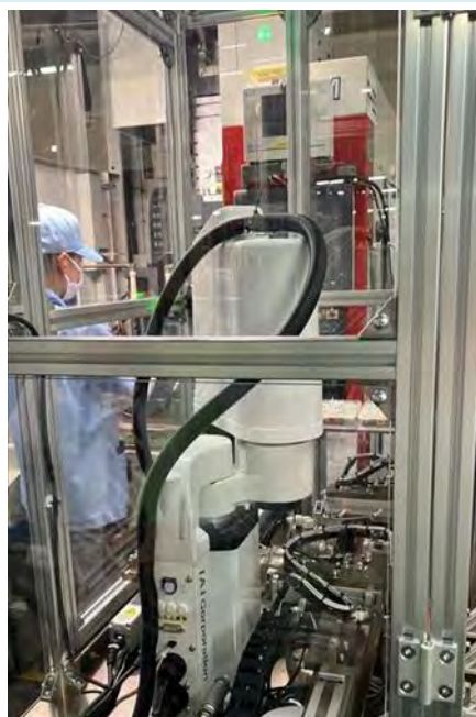
専用器具を使った検査(圧着度)
